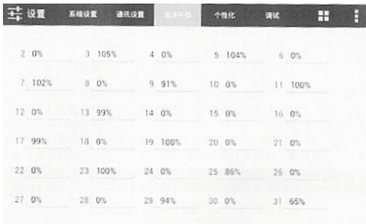
图第二章 SVG 静态无功发生器 2-11 设置-谐波补偿页面
